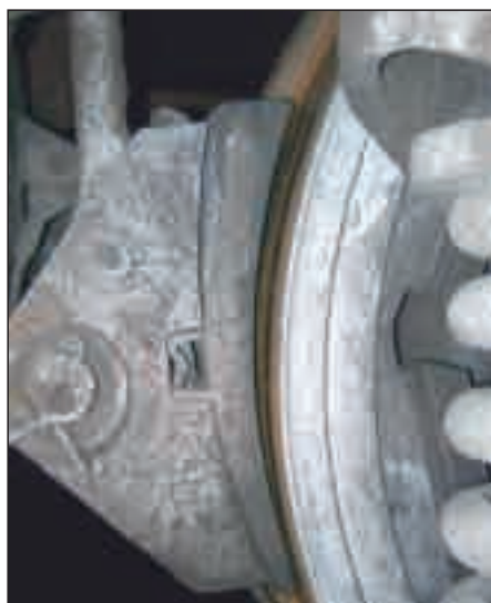
Abb. 8: Asymmetrischer Verschleiß der Sohlen
