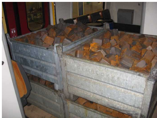
Figuur 2: Foto's belading ICRm met behulp van kratten met remblokken
