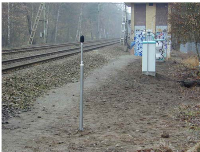
Figuur 4: Meetmicrofoon (voorgond) en geluidmeetpost (rechts).
