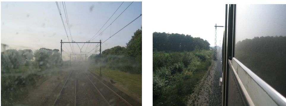
Figuur 4: Rookontwikkeling remblok 3325F op Mat'64
